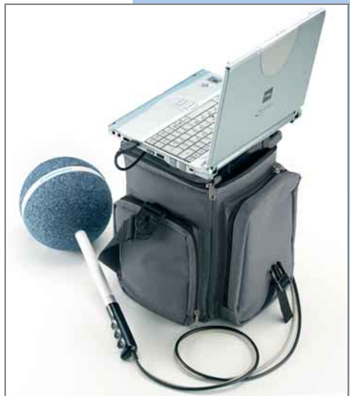
System R&S TS-EMF mit Tragetasche des R&S FSH3
